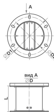
Размеры и вес фланцев KFGV, гибких вставок KFC и обратных клапанов KFG
