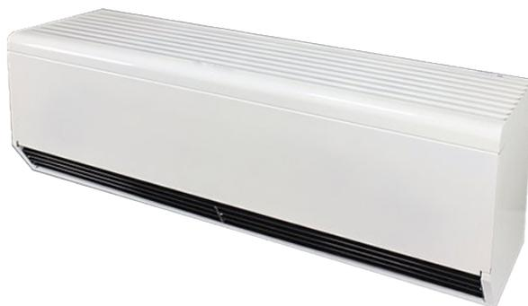
Предназначена для надежной защиты открытых проемов ворот промышленных помещений в случаях, когда в зоне ворот нет постоянных рабочих мест и нет необходимости догревать помещение. Завеса создает мощный воздушный поток, который эффективно защищает проем от врывающегося холодного воздуха. Имеет модульную конструкцию. Завесы позволяют использовать ее на воротах различных размеров, практически без ограничений.
